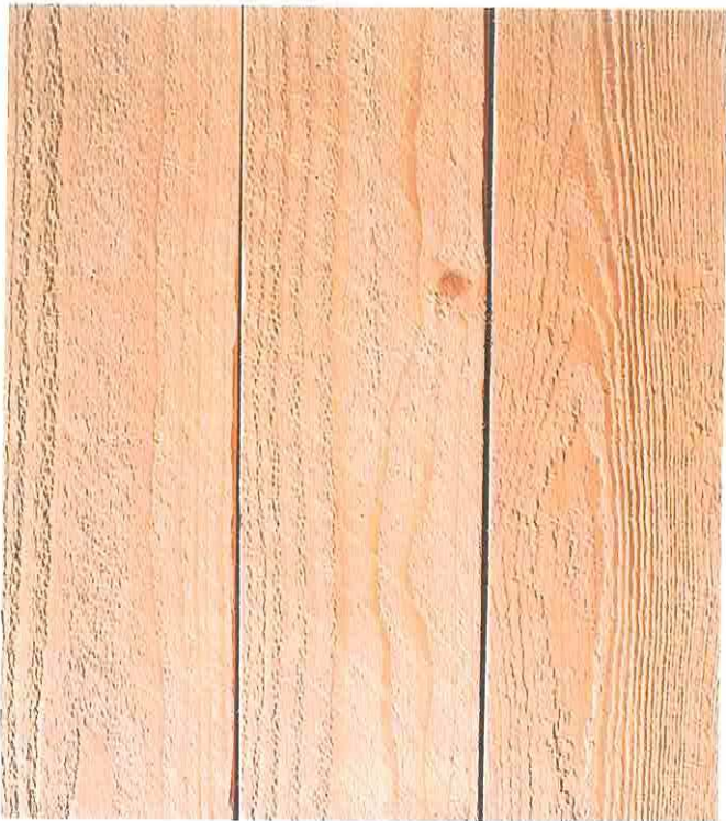
Пиломатериал, раскroенный на круглопильном станке
