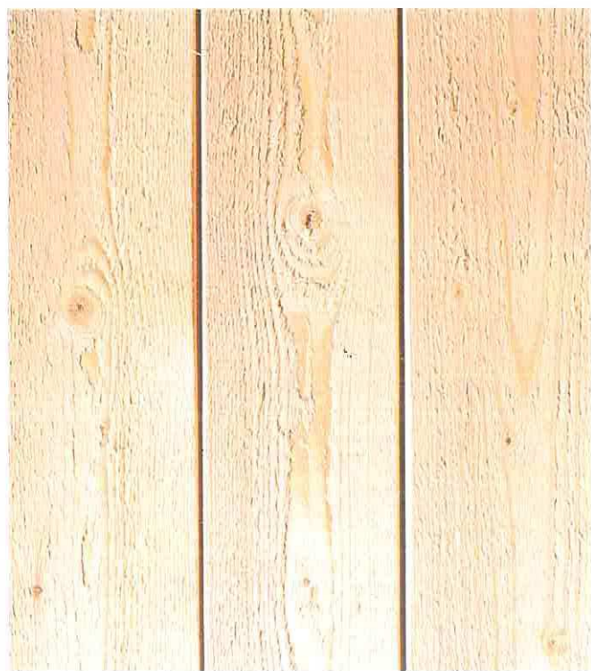
Сухой пиломатериал, раскroенный на ленточнопильном станке
