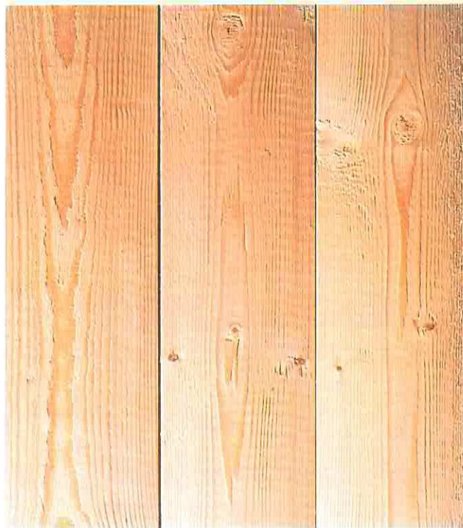
Поверхность, полученная в результате грубой строжки
