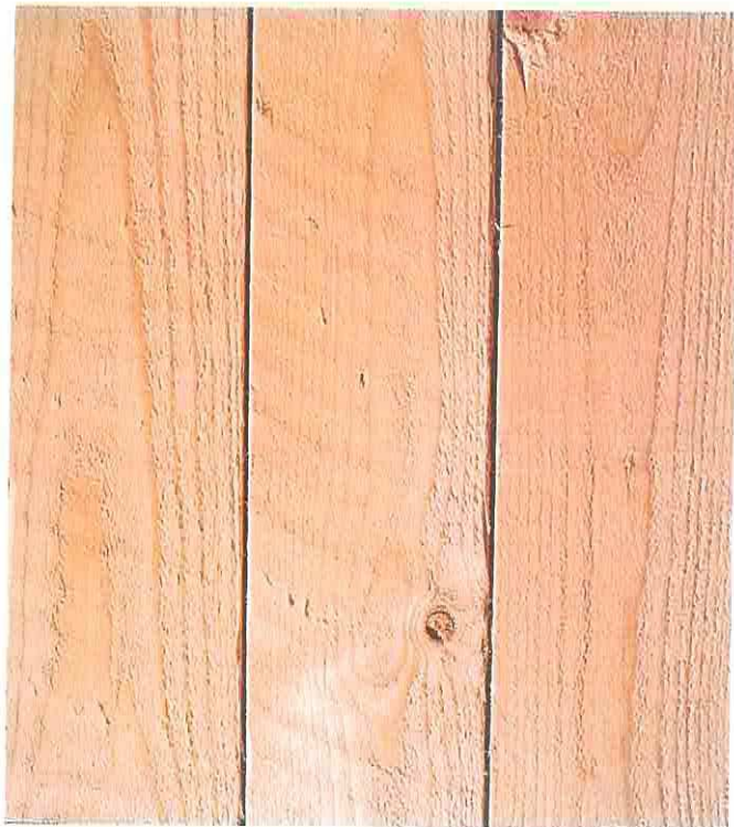
Поверхность, полученная в результате раскroя на фрезерно-брусующем станке
