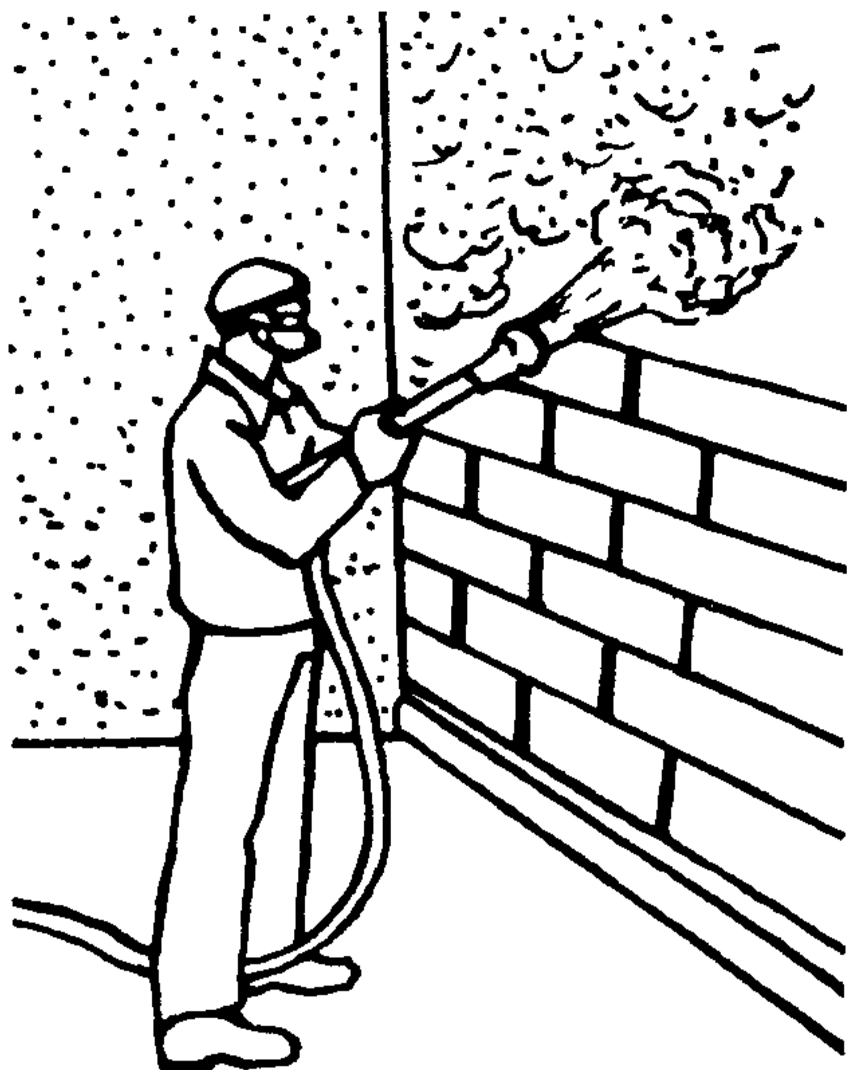
Рисунок 5 – Последовательное нанесение слоев обрызга, грунта
