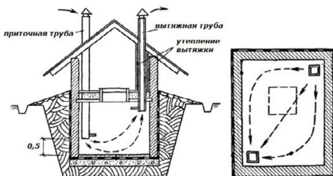
Погреб оснащен приточно-вытяжной вентиляцией естественного типа. Продуманная система позволяет поддерживать внутри помещения необходимый уровень влажности и температурный режим от +3 до 8 градусов.
