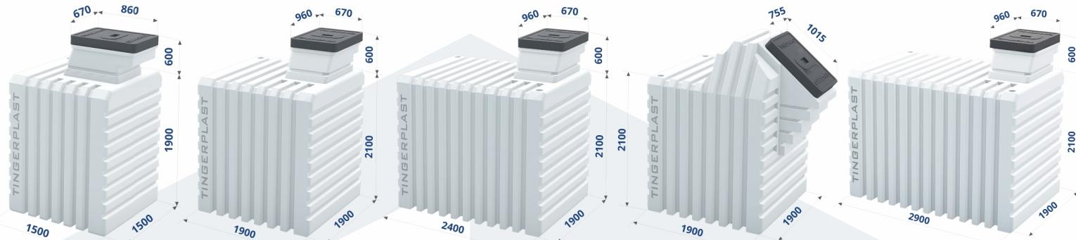
Бесшовный пластиковый погреб, изготовленный из высокопрочного пищевого пластика толщиной до 15 мм по специальной технологии – методом ротационного формования. Благодаря этому изделие не имеет швов сварки. Представляет собой цельную конструкцию и обладает абсолютной герметичностью. Срок эксплуатации погреба TINGARD составляет более 50 лет.
