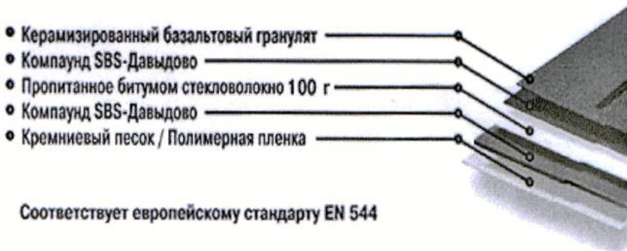
Рис. 1. Строение мягкой кровли Tegola
